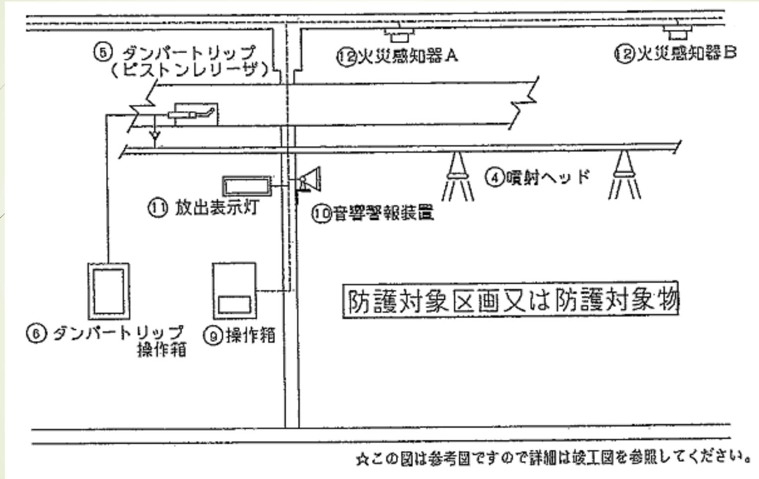
図1.ハロゲン化物(ハロン1301)消火設備構成
