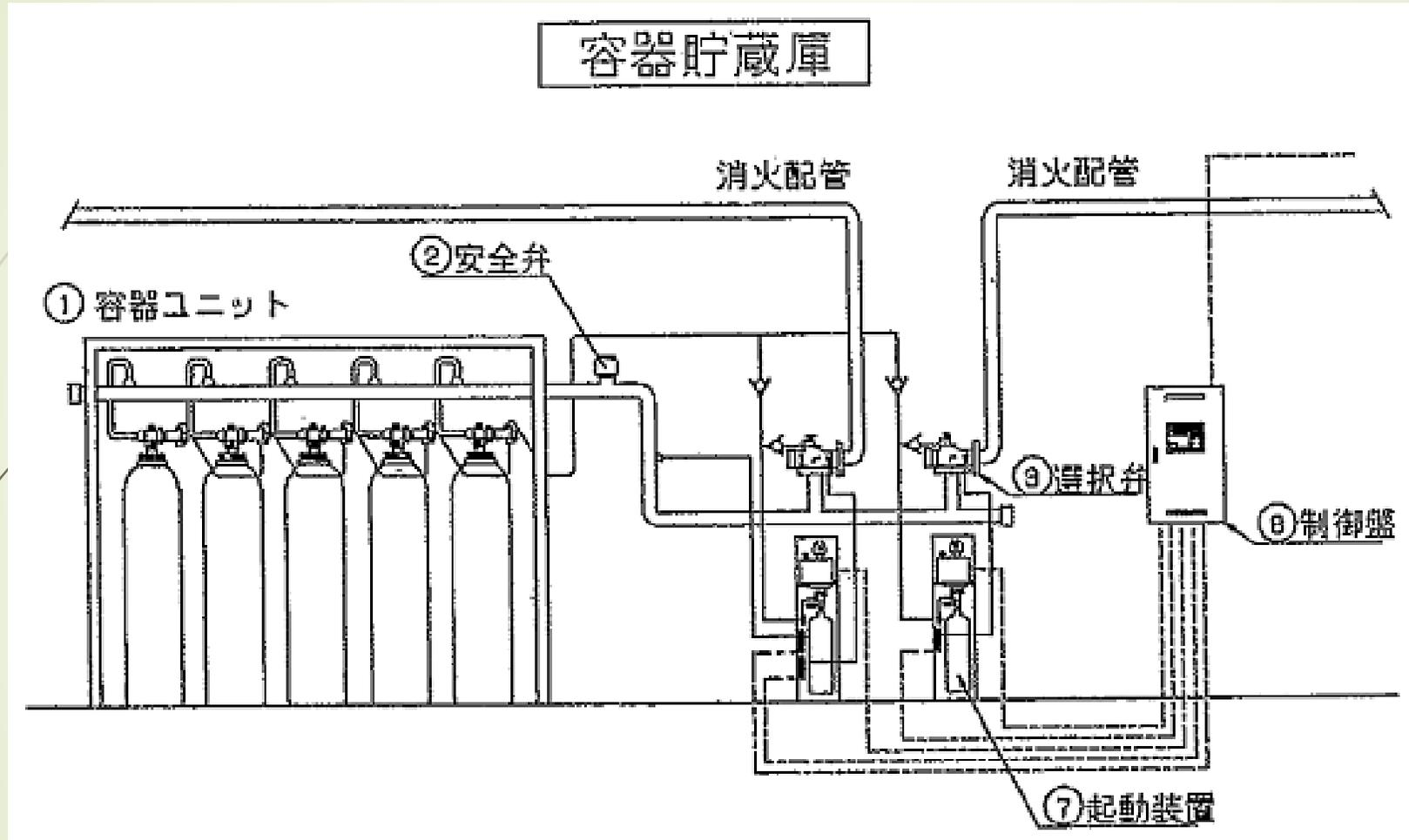
図1.ハロゲン化物(ハロン1301)消火設備構成
